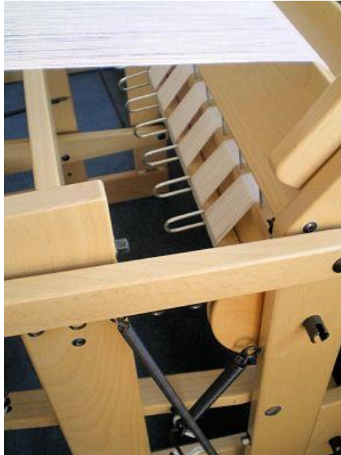
←織機右側後部、バックビーム付近バネを掛け替えて、調整が可能です。
