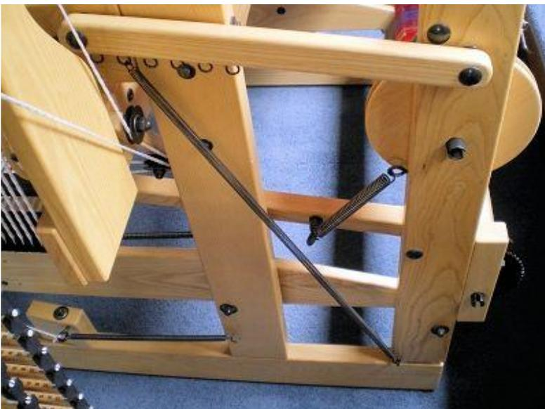
←織機後部右側、オクタドと同じく、長いバネの場所の調整することにより、バックビームのテンションが変わります。
